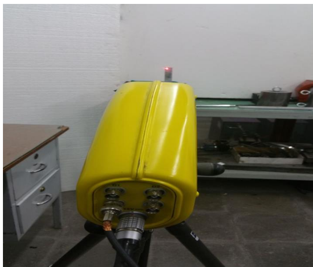
شکل ۱. ارتعاش سنج لیزری مورد استفاده در آزمون مودال محیطی
