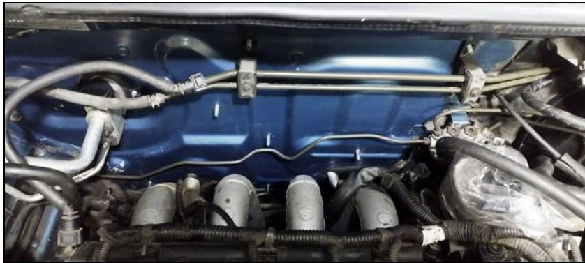
شکل ۳. دیواره آتش بدون عایق استاندارد.
