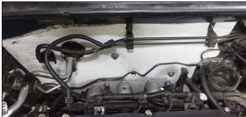
شکل ۴. جایگزینی عایق دیواره آتش با عایق نانو پلی استر.
