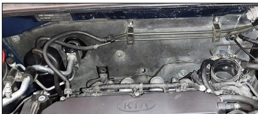
شکل ۲. عایق استاندارد دیواره آتش.
