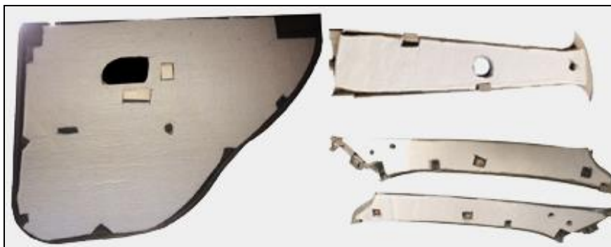
شکل ۸. عایق کاری تزئینات داخلی.
