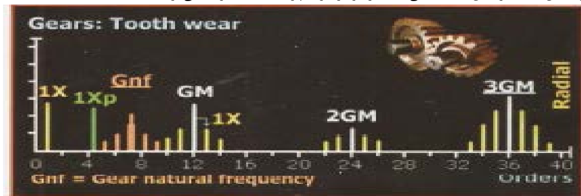
شکل ۳- مشخصه‌های طیف فرکانسی با عیب سایش دنده
