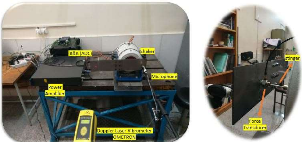
شکل ۴. تجهیزات و چیدمان آزمایش مودال
