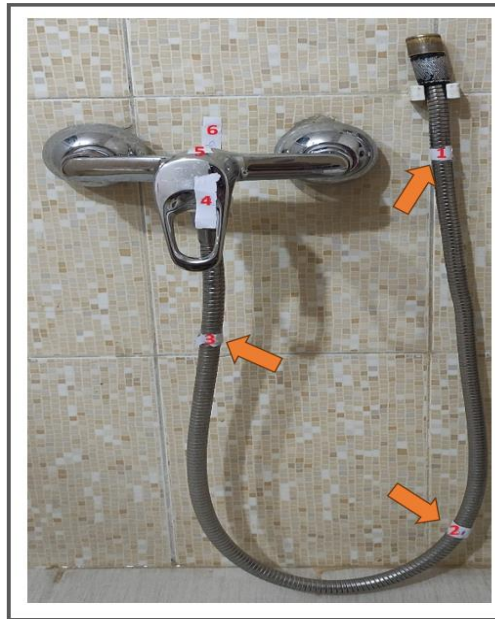
شکل ۴. نقاط قرارگیری میکروفون در آزمایش تشخیص منابع صوتی (نقاط قرارگیری میکروفون بر روی شلنگ با فلش مشخص شده‌اند).
