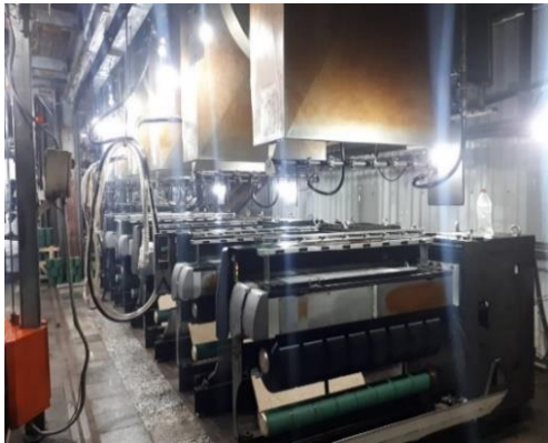
شکل ۱. شش دستگاه تولید نخ در هر مجموعه تولیدی
