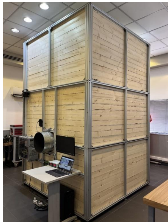
شکل ۵. اتاق آکوستیک و تجهیزات کنترلی محورها.
