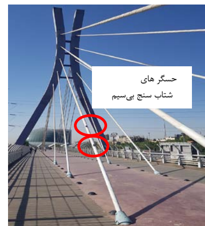
عکس ۳- (راست) ارتعاش محیطی و (چپ) ارتعاش توسط ضربه به غلاف کابل به کمک چکش پلاستیکی
