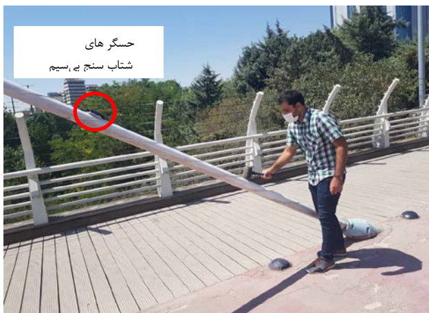
عکس ۳- (راست) ارتعاش محیطی و (چپ) ارتعاش توسط ضربه به غلاف کابل به کمک چکش پلاستیکی
