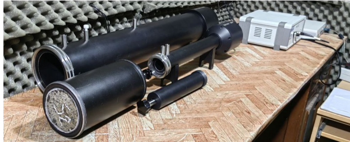
شکل ۲- آزمایش تعیین ضریب جذب صوت با استفاده از لوله امیدانس
