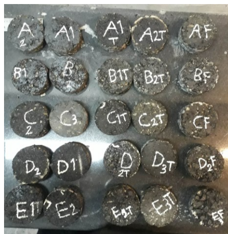
شکل ۱- نمونه‌های گر گرفته شده جهت آزمایش ضریب جذب صوت
