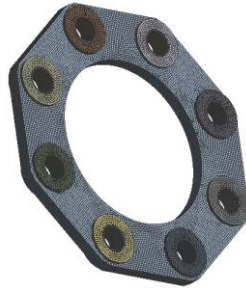
شکل ۴. مدل المان محدود دیسک-پک
